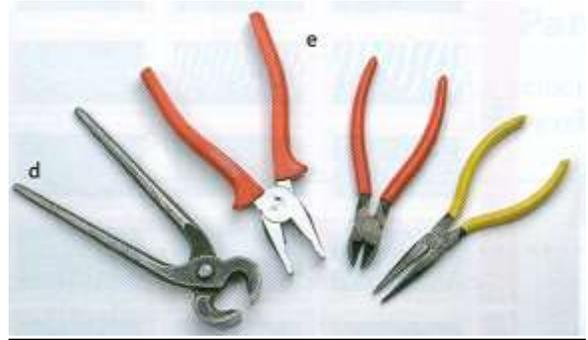
**d) tenazas:** para extraer clavos, sujetar y cortar
